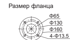
Размер фланца Фланец по стандарту GB/T17241.6 PN6
